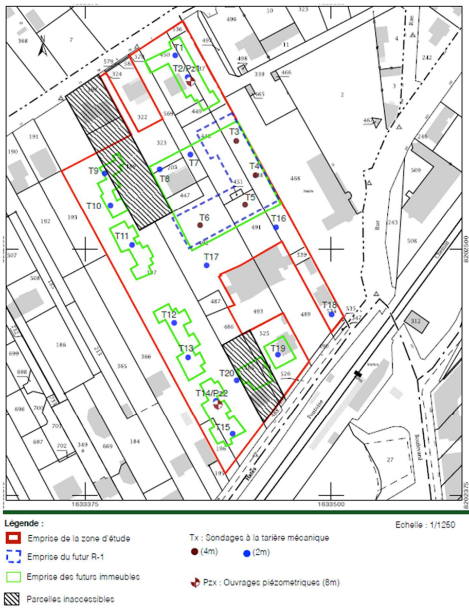
Figure 20: Implantation des sondages sur l'existant
