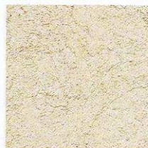
taloché Avec une taloche en bois ou en plastique perforé.
