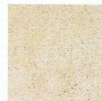
lissé Avec une lisseuse métallique ou le dos de la truelle.
